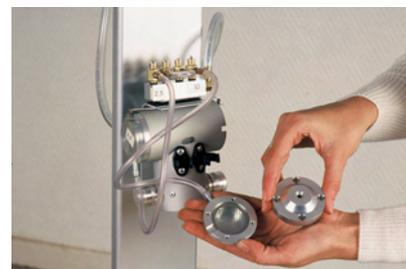
Appareil de prélèvement des particules
