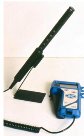
Appareil de mesure de la température, de l'humidité relative et du dioxyde de carbone (Q-Track)
